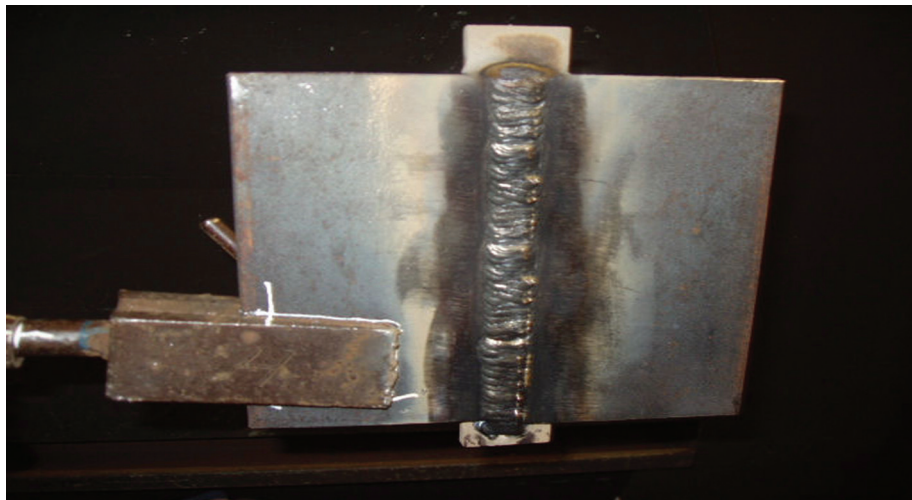
ვერტიკალურ მდგომარეობაში ერთშირიანი შედულებით შედულებული ფირფიტები
