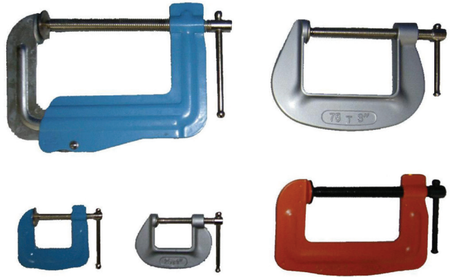
სხვადასხვა ზომისა და ფორმის ჭახრაკები გამოიყენება ლითონის დეტალების სამუშაო მაგიდაზე ან ერთმანეთზე დასამაგრებლად
