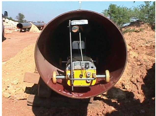
მიღგაყვანილობაში შენადული შეერთების ხარისხის რენტგენოსკოპიული შემოწმების აპარატურა
