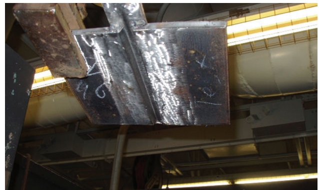
სტენდზე ჭერის მდებარეობაში დამაგრებული შესადუღებლად გამზადებული ფირფიტები
