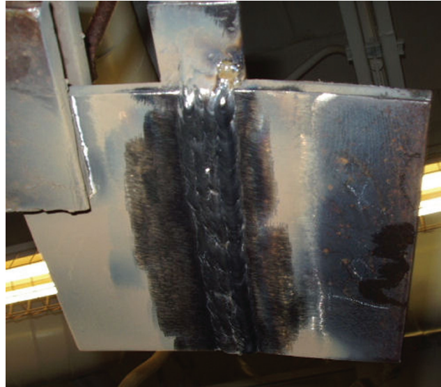
ჭერის მდგომარეობაში შედუღებული მრავალშრიანი ნაკერი
